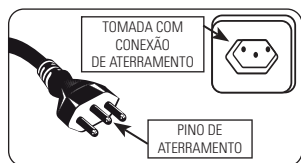
FIGURA 8.1 - CONEXÃO DO PLUGUE A TOMADA (MONOFÁSICO)
