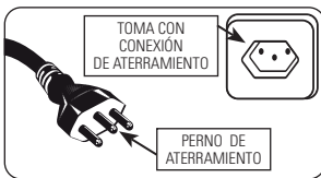
FIGURA 8.1 - CONEXIÓN DEL PERNO A TOMA (MONOFÁSICO)
