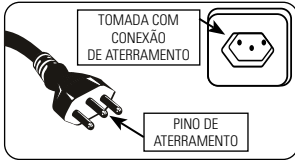
FIGURA 7.1 - CONEXÃO DO PLUGUE A TOMADA (MONOFÁSICO)
