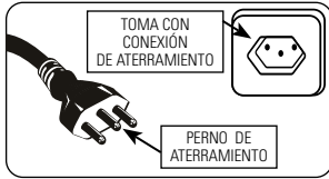
FIGURA 7.1 - CONEXIÓN DEL PERNO A TOMA (MONOFÁSICO)
