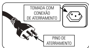
FIGURA 8.1 - CONEXÃO DO PLUGUE A TOMADA (MONOFÁSICO)
