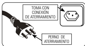
FIGURA 8.1 - CONEXIÓN DEL PERNO A TOMA (MONOFÁSICO)
